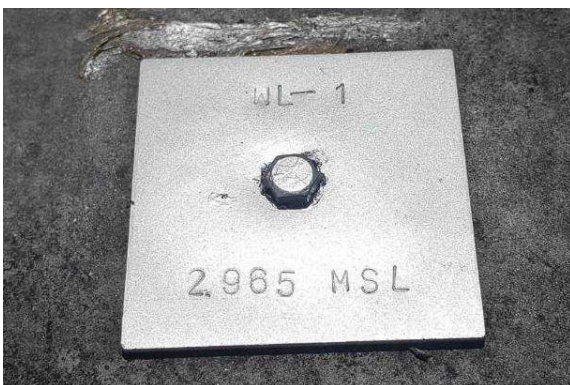
ข. หมุดควบคุมบริเวณท่าเทียบเรือ บริษัท เอเชีย โกลเด็นท์ โรส จำกัด
