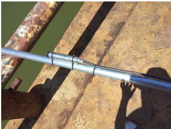
ก. การติดตั้งเครื่องวัดระดับน้ำบริเวณท่าเทียบเรือ บริษัท เอเชีย โกลเด็นท์ ไรซ์ จำกัด
