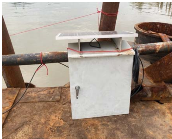
ข. การติดตั้งเครื่องวัดระดับน้ำบริเวณท่าเทียบเรือ บริษัท ซี พอร์ท จำกัด
