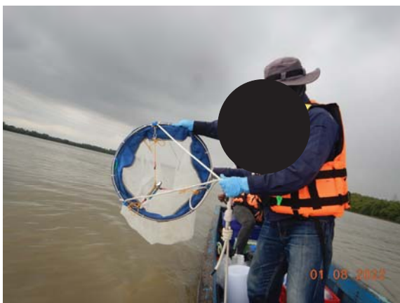
ถุงลากเก็บตัวอย่างสัตว์น้ำวัยอ่อน ที่ติดตั้ง Flow Meter ไว้กึ่งกลางปากถุง
