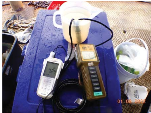
การตรวจวัดค่า pH, Temperature
